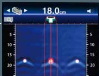
Peut également détecter des objets courbés en diagonale dans le béton, tels que des conduits combinés ou des tuyaux en plastique souples
