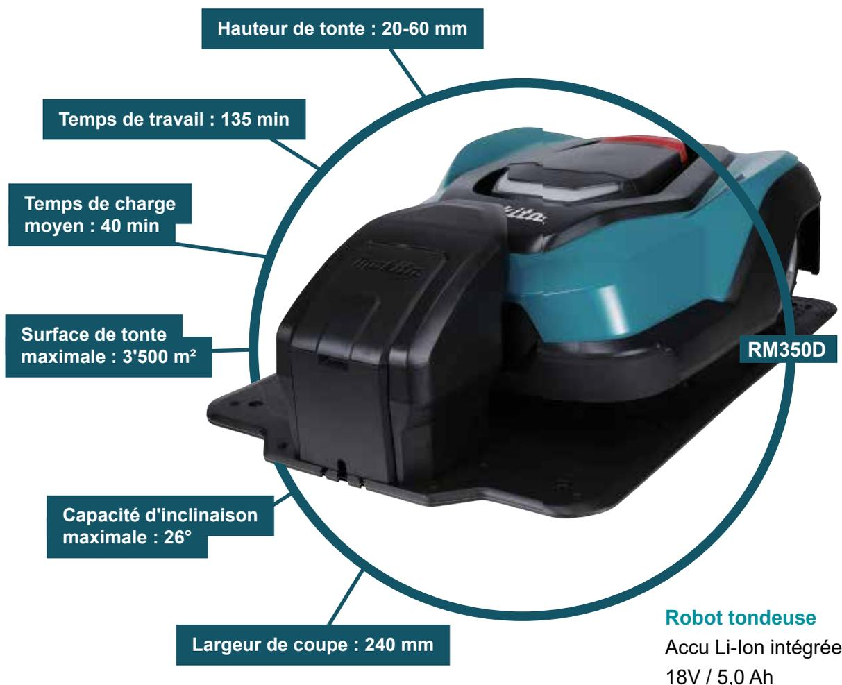
Le RM350D a la capacité de tondre une superficie maximale de 3'500 m<sup>2</sup>.
