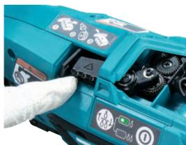
**2** Mettez une bobine et passez un fil à travers le trou
